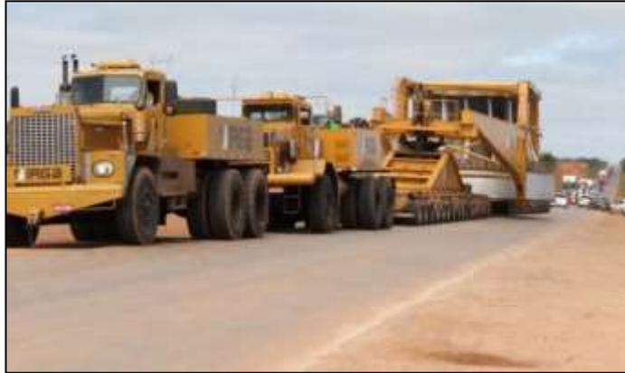
**Figura 5.** Transporte de rotor para da Usina Hidrelétrica de Teles Pires, pela rodovia BR-163.
